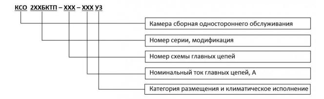
Пример записи условного обозначения ячейки КСО 2XXБКТП при его заказе и в документации другого изделия:
